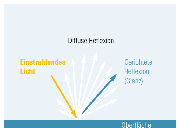
Abb. 5 // Diffuse und gerichtete Reflexion von Licht auf einer planen Oberfläche.
